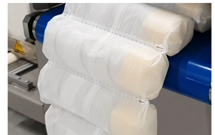
Die fertige Kombinationstaschenschlange.
